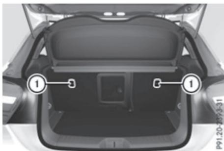
Los anclajes Top Tether se encuentran en la parte posterior de los respaldos de ambos asientos exteriores traseros.
