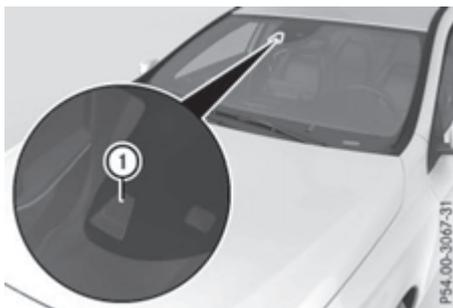
El detector de carril con aviso por vibración vigila la zona que se encuentra delante del vehículo mediante una cámara multifuncional ① fijada en la parte superior del interior del parabrisas. Si el detector de carril con aviso por vibración detecta marcas de limitación de carril en la calzada, podrá advertirle en caso de abandono involuntario del carril.
