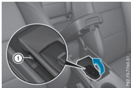
Puede levantar el soporte preinstalado para acceder mejor al compartimento portaobjetos.
