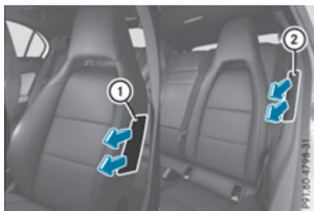
Los airbags laterales delanteros ① y los airbags laterales del espacio posterior ② se despliegan junto a los refuerzos laterales exteriores del respaldo del asiento.
