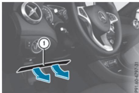
El airbag para las rodillas del conductor ① se despliega debajo de la columna de la dirección. El airbag para las rodillas del conductor se activa junto con los airbags delanteros.
