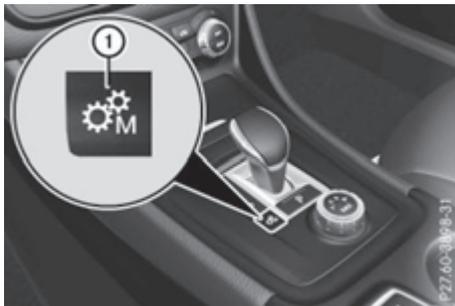
► **Activación:** acople la palanca selectora en la posición D.
