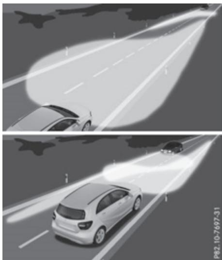
Con esta función puede activar el cambio automático entre la luz de cruce y la luz de carretera. El sistema detecta los vehículos que tienen las luces encendidas y circulan en dirección contraria o por delante del propio y conmuta en estos casos de la luz de carretera a la luz de cruce.
