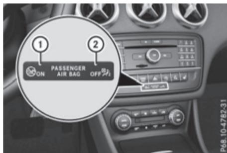
Los testigos de control PASSENGER AIR BAG ON ① y PASSENGER AIR BAG OFF ② forman parte del sistema de desconexión automática del airbag del acompañante.
