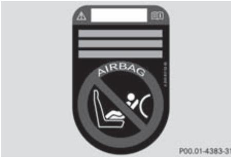
Si su vehículo no dispone de un sistema de desconexión automática del airbag del acompañante, estará marcado con un rótulo adhesivo especial. Este rótulo adhesivo está fijado en el lado del acompañante, en el lateral del tablero de instrumentos. El rótulo adhesivo queda visible al abrir la puerta del acompañante.
