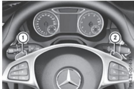
► **Acoplamiento de una marcha superior:** tire de la leva de cambio del volante ②. El cambio automático acopla la marcha inmediatamente superior.
