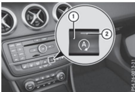
► **Desconexión:** pulse la tecla ECO ①. El testigo de control ② y el símbolo ECO
