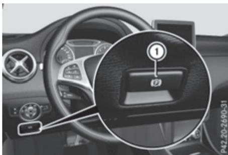
▶ **Accionamiento:** presione el asidero ①. Si el freno de estacionamiento eléctrico está activado, se ilumina el testigo de control rojo
