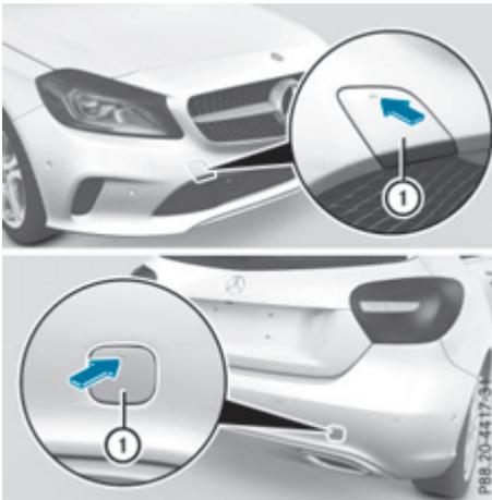
Los alojamientos de la argolla enroscable para remolcado se encuentran en los paragolpes, debajo de sendas cubiertas ① situadas en la parte delantera y trasera del vehículo.
