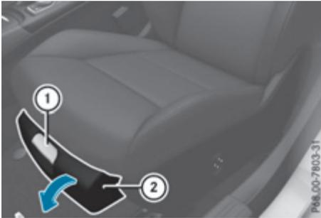
► **Apertura:** tire del asidero ① hacia arriba y abra la cubierta ② desplazándola hacia delante.
