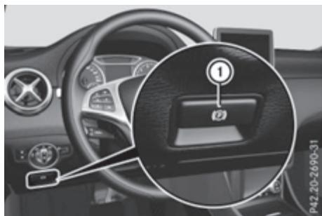
Al arrancar en pendientes puede utilizar el freno de estacionamiento eléctrico para evitar que el vehículo ruede hacia atrás.
