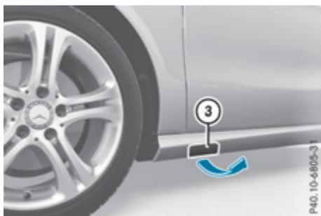
Cubierta delantera (ejemplo vehículos con equipamiento AMG)
